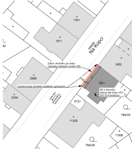
Rozsah záboru po dobu provádění demolice RD a výstavby základů nového RD
