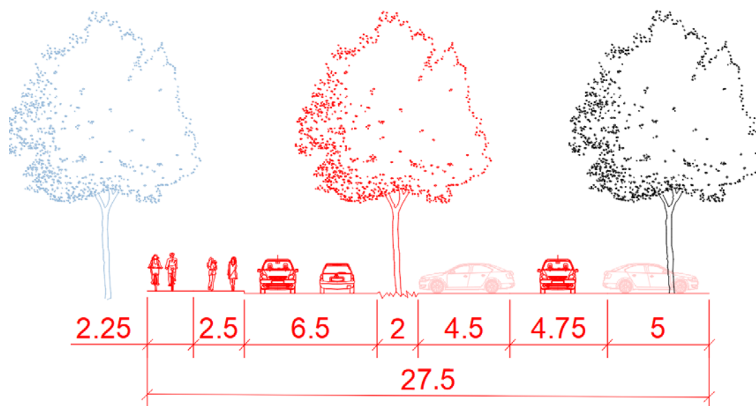
Obrázek 23 Příčné uspořádání ulice K Židovskému hřbitovu (červeně jsou vyznačeny změny oproti stávajícímu stavu, modře zeleň řešená v rámci rozvojové lokality SKN)
