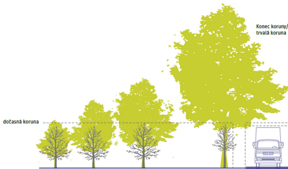
Obr. 14: Princip převedení koruny dočasné na korunu trvalou.
