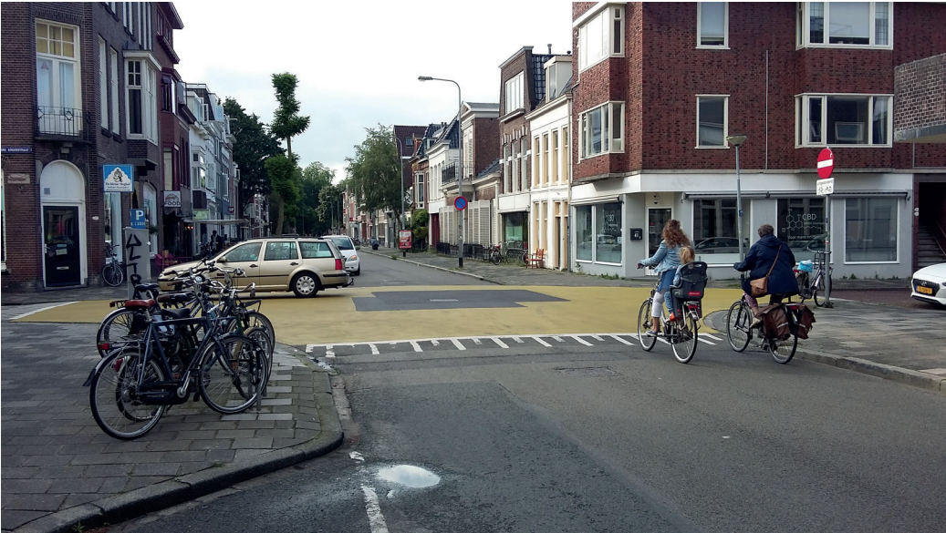
Možné uspořádání uličního prostoru v zóně 30 se zvýšenou plochou křižovatky, která nutí řidiče zpomalit, stejně tak jako povinnost přednosti zprava. Rampy zvýšené plochy křižovatky jsou navrženy tak, aby umožnily pohodlnou jízdu cyklistů. Groningen, Nizozemsko, Foto: Z. Sperat
